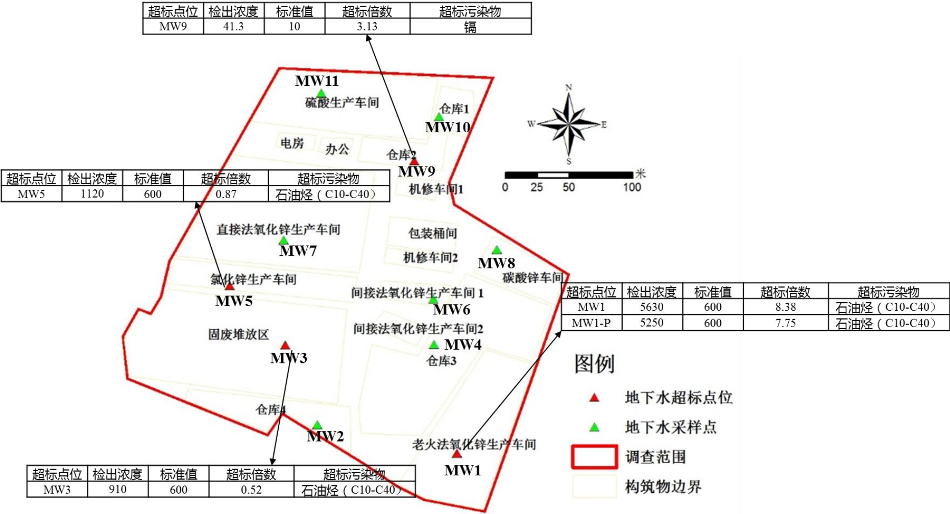
图 8.6-2 地下水超标点位分布图（单位：μg/L）
