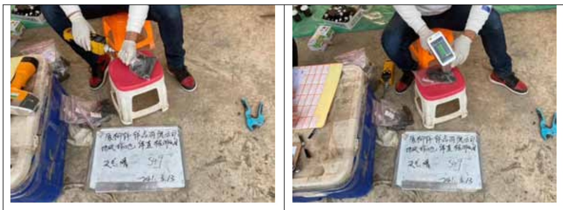
图 7.2-6 土壤样品快速检测照片（左为 PID，右为 XRF）
