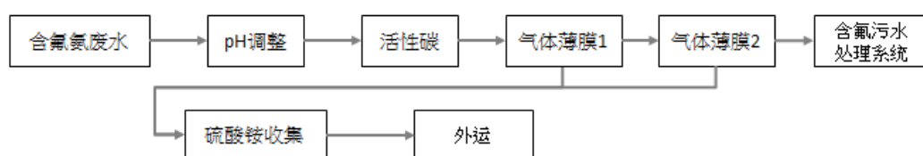
图3.4-14 含氟氨废水处理工艺流程
